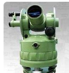
L'opérateur peut utiliser cet appareil pour mesurer l'altitude d'un point donné ; par exemple, on a schématisé la situation suivante, où  $O$  est l'emplacement de l'oeil de l'observateur (lunette du théodolite) :
